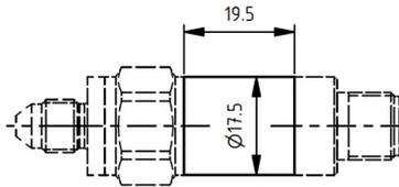
Fig. 9 - Variante für Spannungsausgang (0.5 ... 4.5 VDC)
